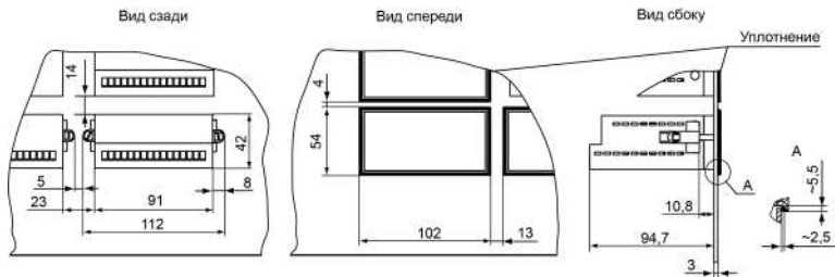
Рисунок 4.10 – Прибор в корпусе Щ2, установленный в щит толщиной 3 мм
